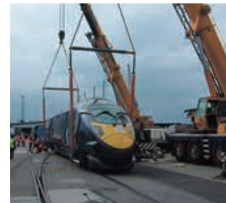
◀ 英国に初めて輸出される鉄道車両(日立製作所製)を一貫輸送(サウサンプトン港でレール上へ荷卸し)
